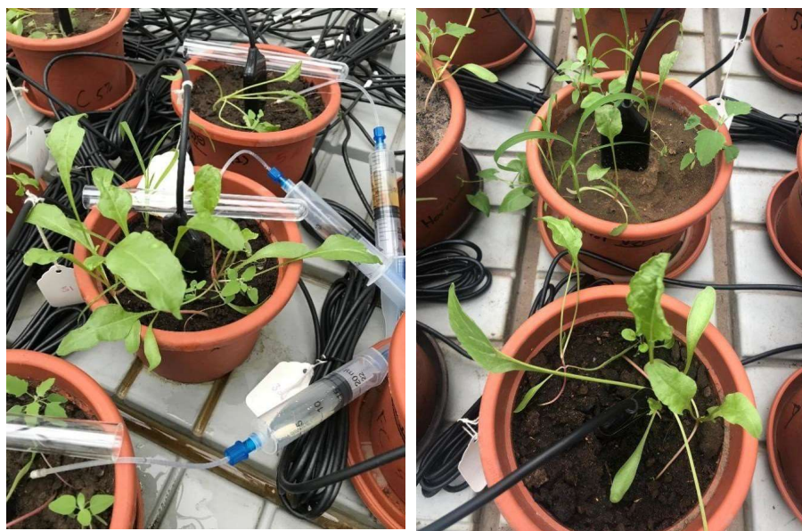
Obrázek 3. Nádobový experiment s instalovanými vlhkostními čidly FDR a rhizony.
