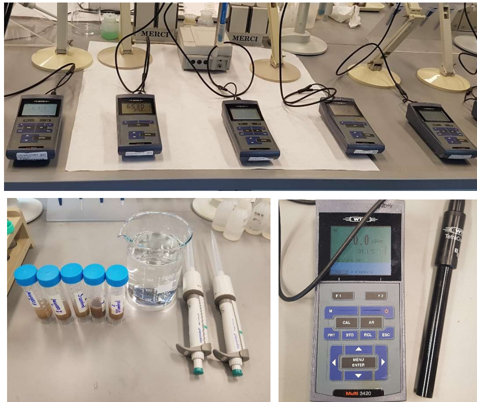
Obrázek 4. Měření pH a Ec (elektrická vodivost), pomocí multimetru a konduktometru.
