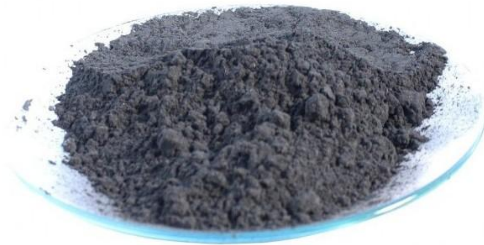
Obr. 8 – Jemně mletý grafit frakce 0,025 mm [7]
