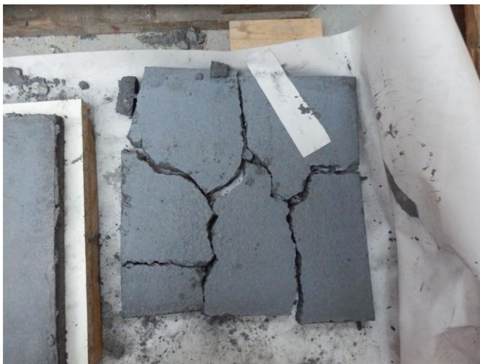
Obr. 14 – Popraskání vzorků s příměsí grafitu
