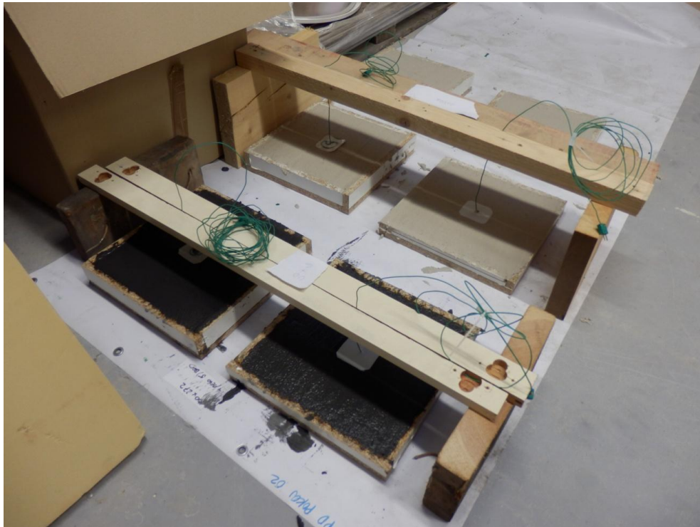
Obr. 13 – Aretace teplotního čidla v kolmé poloze
