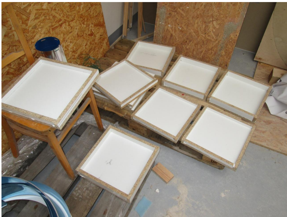
Obr. 11 – Formy zhotovené z dřevotřískových desek
