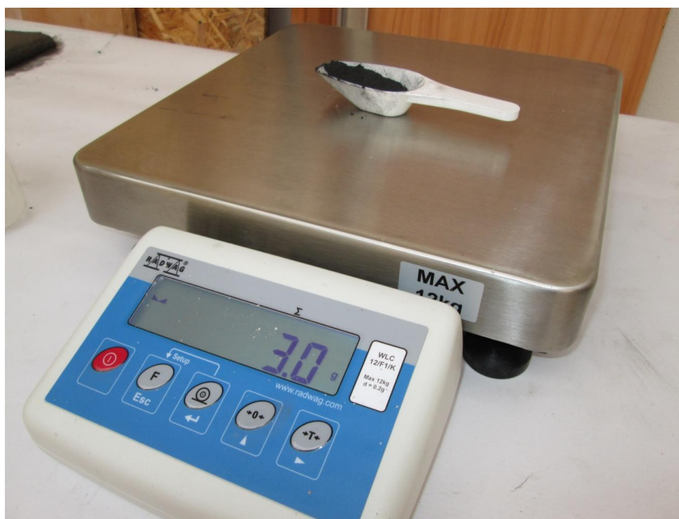
Obr. 9 – Vážení grafitu na laboratorní váze Radwag WLC 12/F1/K
