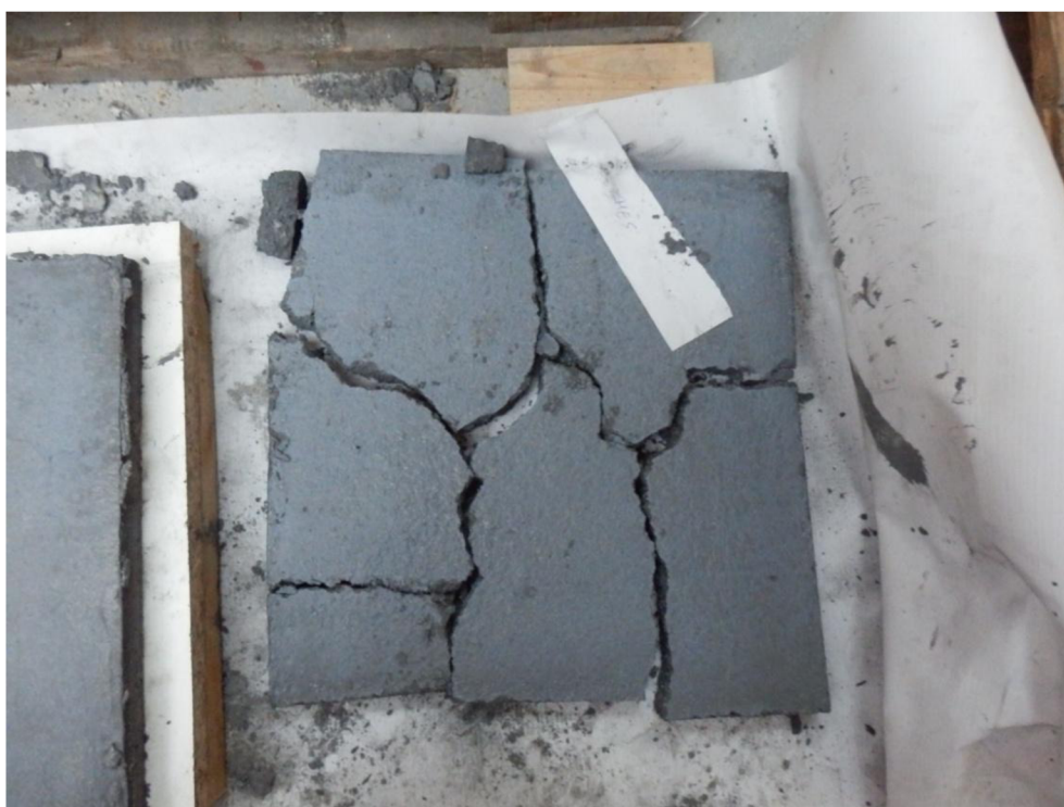
Obr. 14 – Popraskání vzorků s příměsí grafitu
