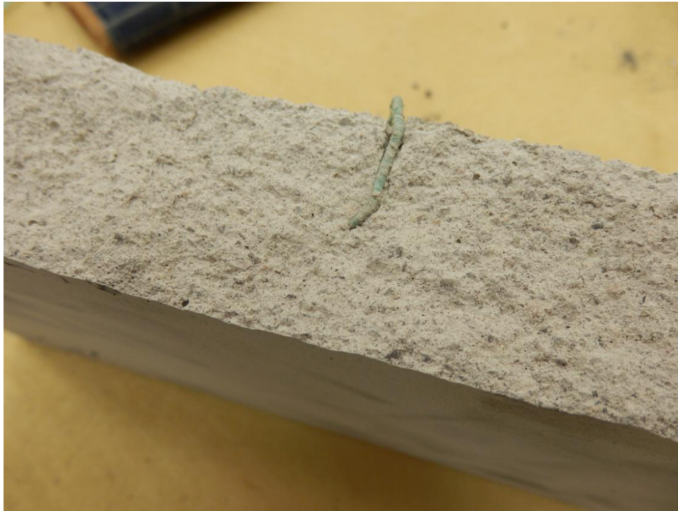
Obr. 21 – Znárodnění umístění čidla uprostřed vzorku
