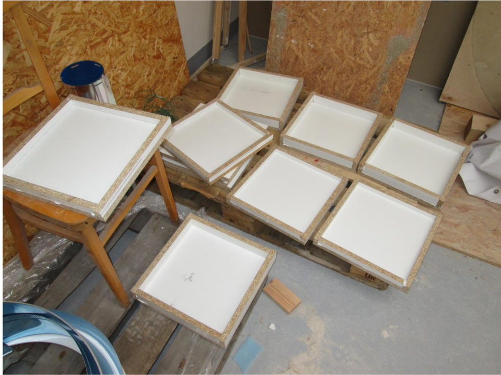
Obr. 11 – Formy zhotovené z dřevotřískových desek
