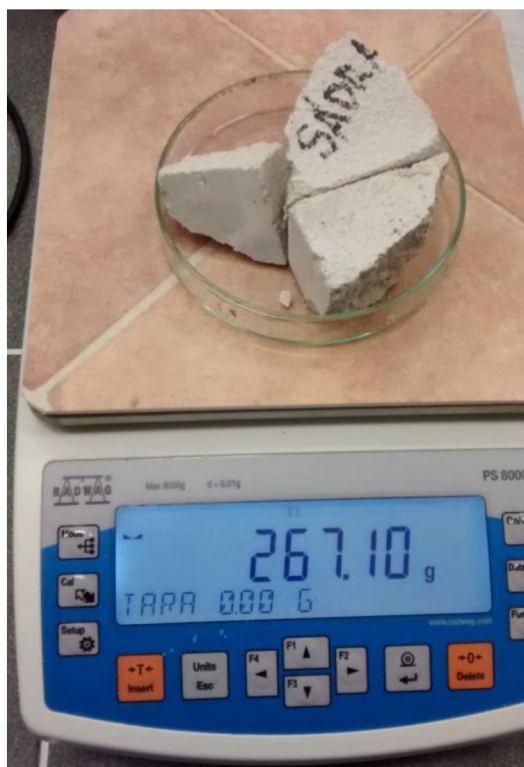
Obr. 23 – Vážení vysušených úlomků vzorků pro stanovení orientační vlhkosti vzorků
