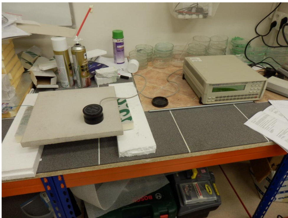
Obr. 20 – Stanovení součinitele tepelné vodivosti \lambda pomocí Isometu model 2104
