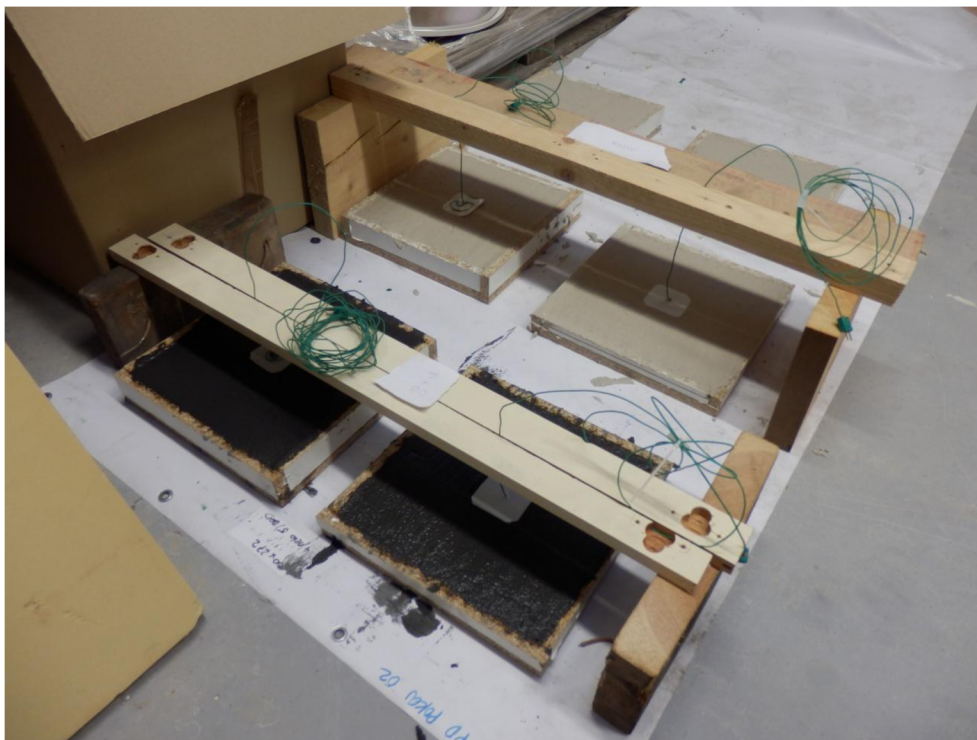
Obr. 13 – Aretace teplotního čidla v kolmé poloze
