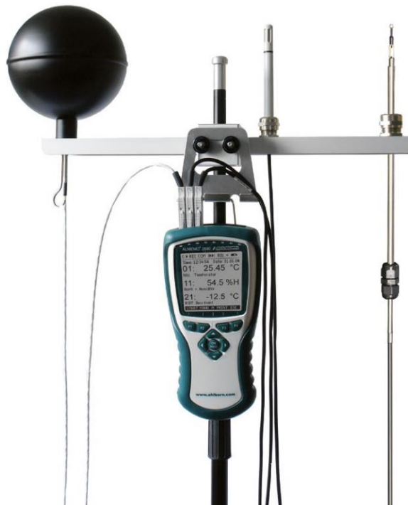
Obrázek 1: Sestava pro měření klimatických podmínek
