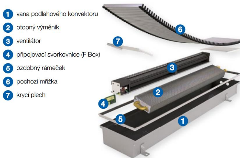
Obrázek 3: Sestava podlahového konvektoru
