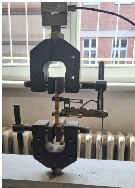
Obr. 19: Zařízení pro stanovení smykové pevnosti lisu Testometric M350-20CT
