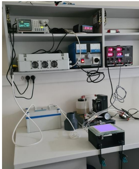
Obr. 17 : Zařízení pro aplikaci plazmatického výboje Lifetech VF700
