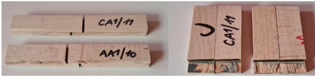
Obr. 18: Zkušební tělesa před zkouškou a po zkoušce smykové pevnosti
