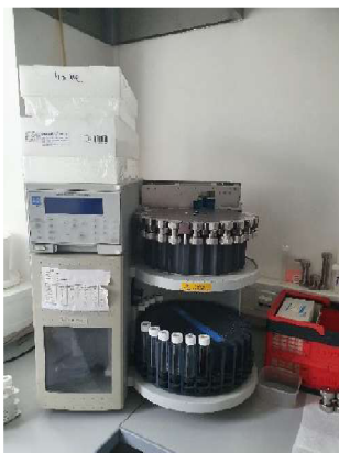
Obrázek 6 - extraktor Dionex ASE 200
