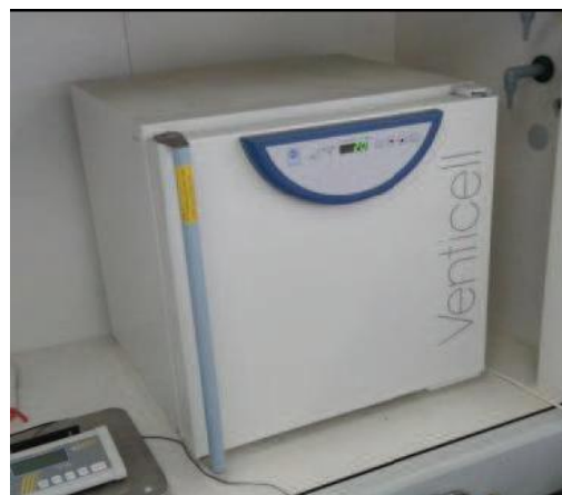
Obrázek 10 Sušárna BMT Venticell 22
