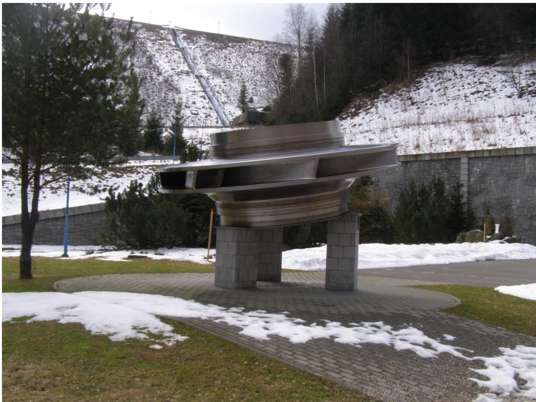
Příloha č. 2. Francisova turbína před vchodem do podzemní elektrárny (Zdroj: Autor)
