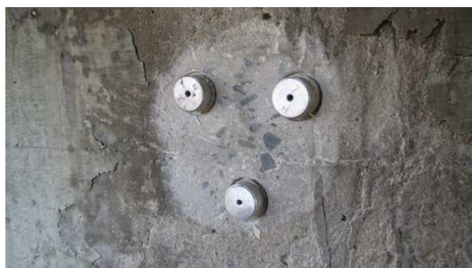
Obrázek P2. 49: Pohled na zkušební místo PO4 s nalepenými zkušebními terči
