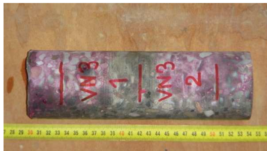
Obrázek P2. 20: Laboratorní foto vývrtní VN3 před úpravou na zkušební vzorky
