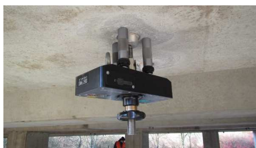
Obrázek P2. 28: Trhací automatický přístroj Proceq DYNA DY-216
