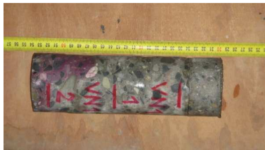
Obrázek P2. 4: Laboratorní foto vývrtu VNI před úpravou na zkušební vzorky
