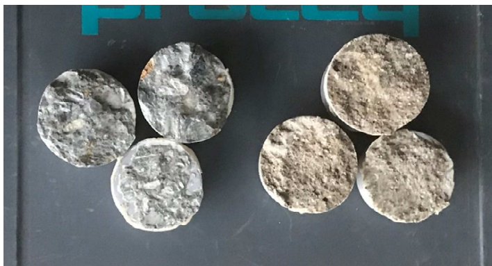
Obrázek 38: Detail textury betonu po provedení odtrhových zkoušek, levá strana: prefabrikovaný beton mostních nosníků, pravá strana: beton monolitické opěry [41]
