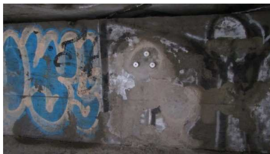
Obrázek P2. 47: Pohled na zkušební místo PO1 s nalepenými zkušebními terči
