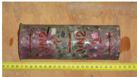
Obrázek P2. 12: Laboratorní foto vývrtu VN2 před úpravou na zkušební vzorky
