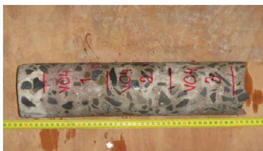
Obrázek P2. 46: Laboratorní foto jádrového vývrtnu VO4 s provedenou fenolftaleinovou zkouškou a naznačeným příčným dělením na zkušební vzorky
