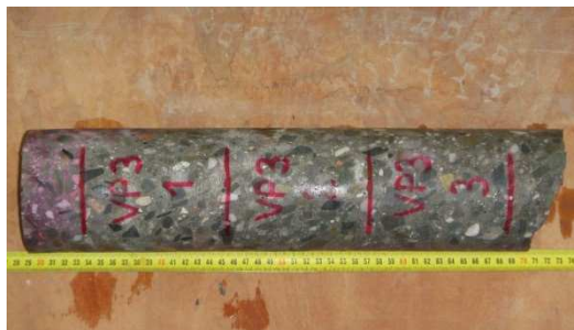
Obrázek P2. 34: Laboratorní foto jádrového vývrtního otvoru VP3 s provedenou fenolftaleinovou zkouškou a naznačeným příčným dělením na zkušební vzorky
