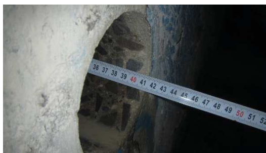
Obrázek P2. 40: Hloubka provedeného jádrového vývrtu VO1
