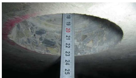
Obrázek P2. 2: Délka odvrtnutí – sonda VN1
