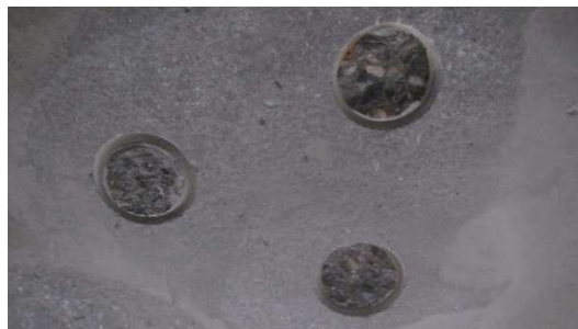
Obrázek P2. 26: Zkušební místo PN1 po provedené odtrhové zkoušce
