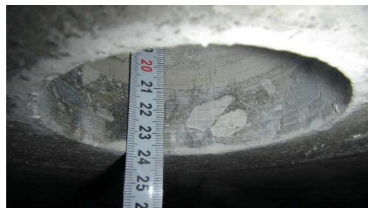
Obrázek P2. 18: Délka odvrtu – sonda VN3
