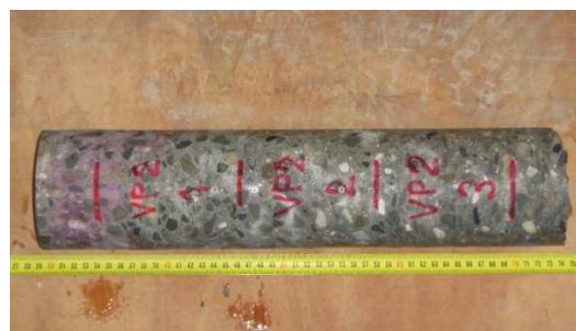
Obrázek P2. 30: Laboratorní foto jádrového vývrtu VP2 s provedenou fenolftaleinovou zkouškou a naznačeným příčným dělením na zkušební vzorky
