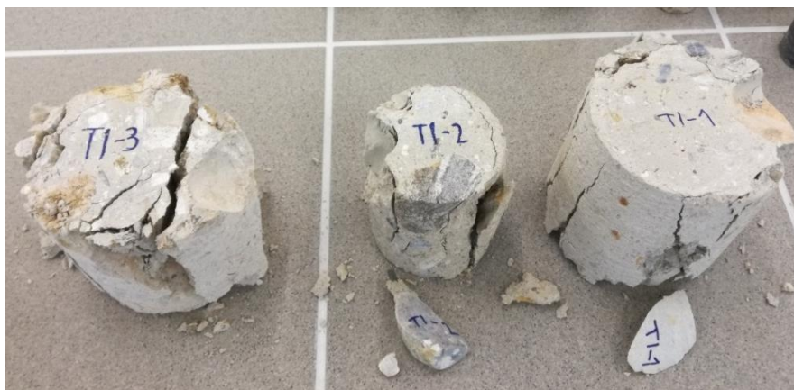
Obrázok 3-24: Porušené skúšobné teleso T1 na konci jednoosej tlakovej skúšky
