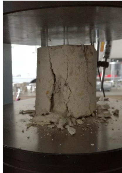
Obrázok 3-24: Porušené skúšobné teleso T1 na konci jednoosej tlakovej skúšky
