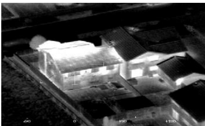
Obrázek 7 – Měření termovizním zařízením z vrtulníku. Bílá barva střechy vykazuje zvýšený únik tepelného záření 21
