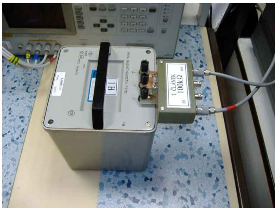
Obrázek 9.1: Způsob měření pomocí T článku.
