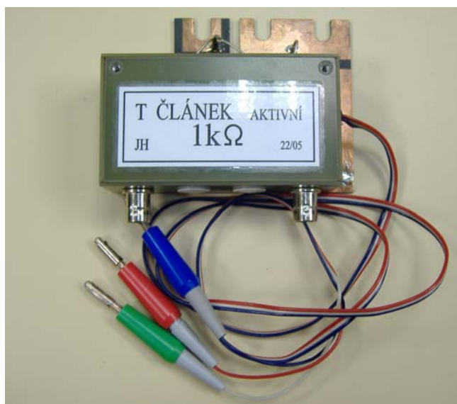
Obrázek 8.3: Konstrukční provedení aktivního T článku 1 k \Omega – celkový pohled.
