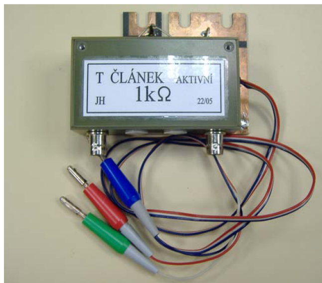
Obrázek 8.3: Konstrukční provedení aktivního T článku 1 k \Omega – celkový pohled.
