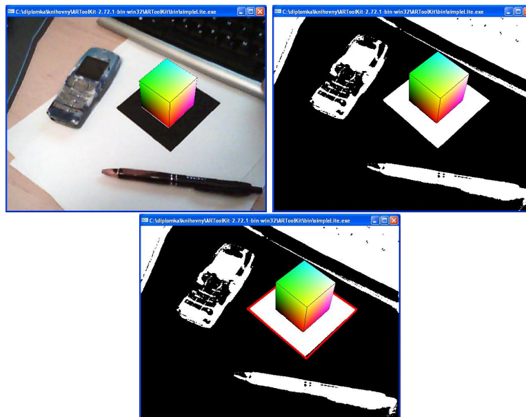
Obrázek 7.8: Vyhledání a označení pozice markeru ve snímku. Snímek je nejprve prahován a pak v něm nalezen marker.
