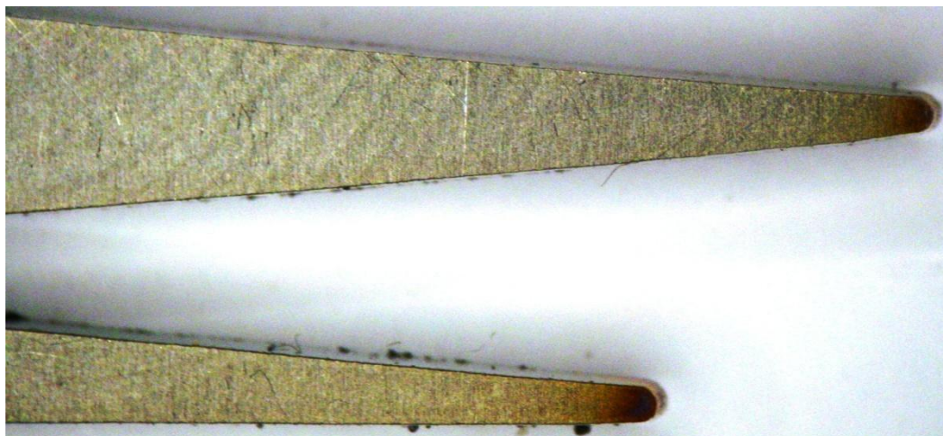
Obr. 5.13 Detail oblasti ostrých hran vyrobených CO 2 laserem
