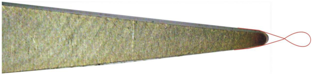
Obr. 5.14 Detail trojúhelníkové plochy s naznačenou zpětnou smyčkou nástroje
