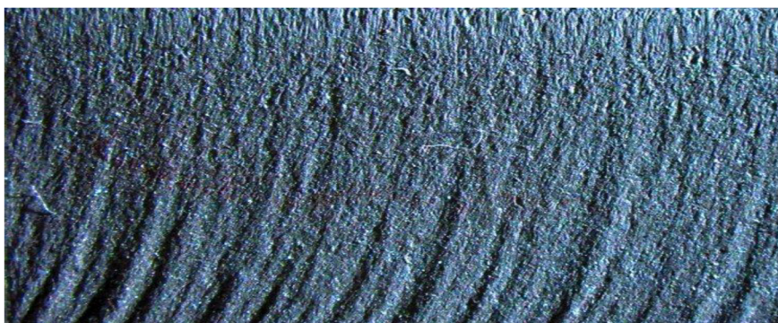
Obr. 5.7 Charakteristika profilu vzorku řezaného metodu AWJ označená hodnotou Q3 [38]
