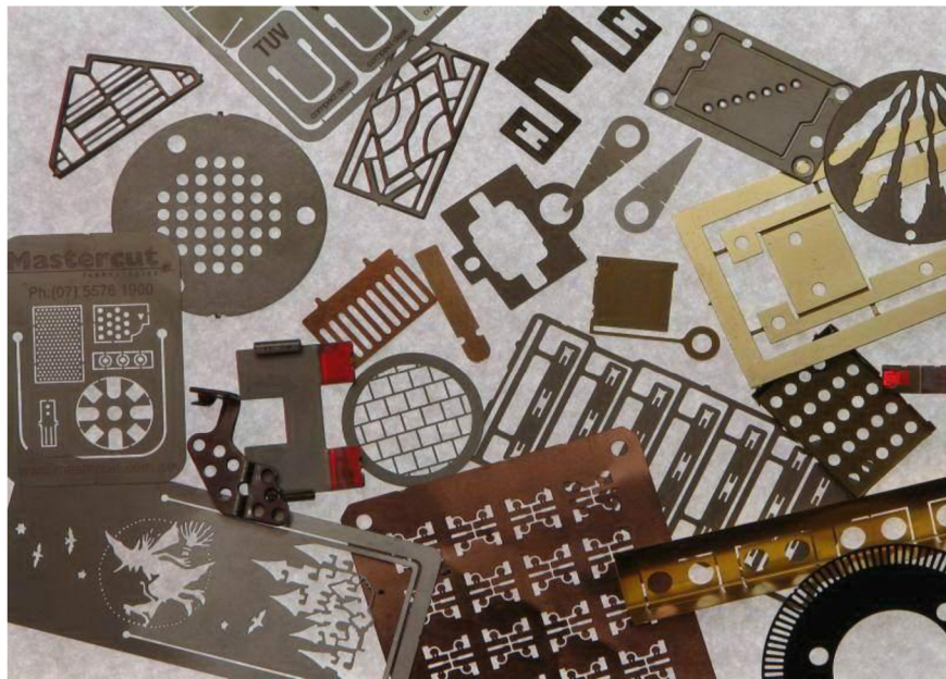
Obr. 2.11 Dílce vyráběné chemickým obráběním [11]
