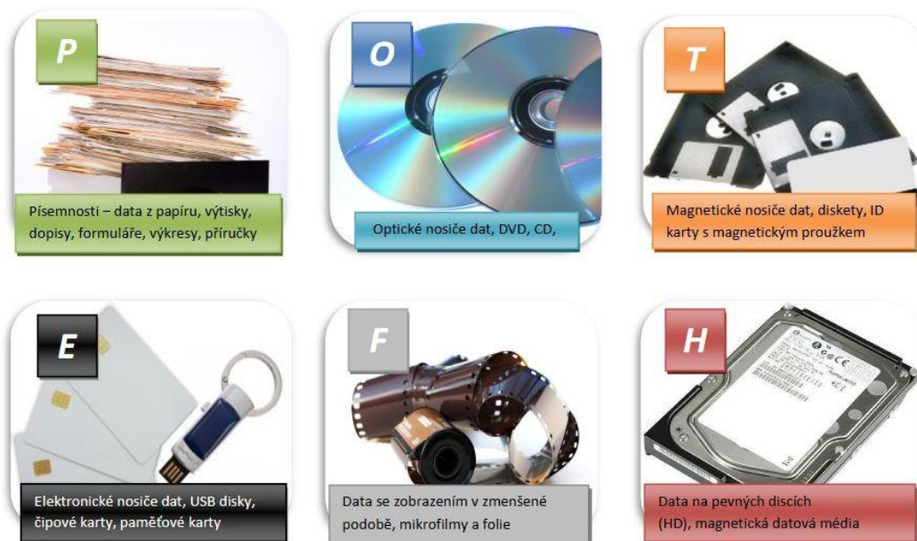
Obr. 1: Klasifikace dle DIN 66399
