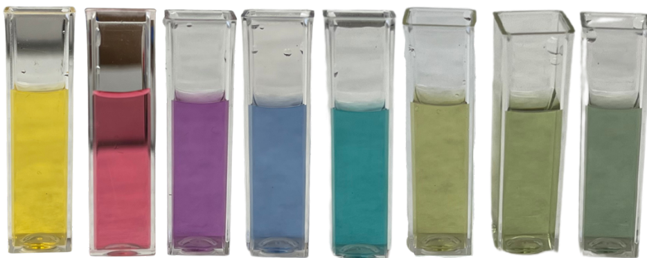
Obrázek č. 13: Ukázka barevného spektra připravených disperzí nanočástic stříbra v závislosti na množství přídavku citranu (zleva 0,25 ml; 0,75 ml; 1 ml; 1,5 ml; 2,5 ml; 3 ml; 3,5 ml; 5 ml). Pro lepší rozpoznání barev jsou disperze 10x zředěny. [Upraveno z vlastních fotografií]
