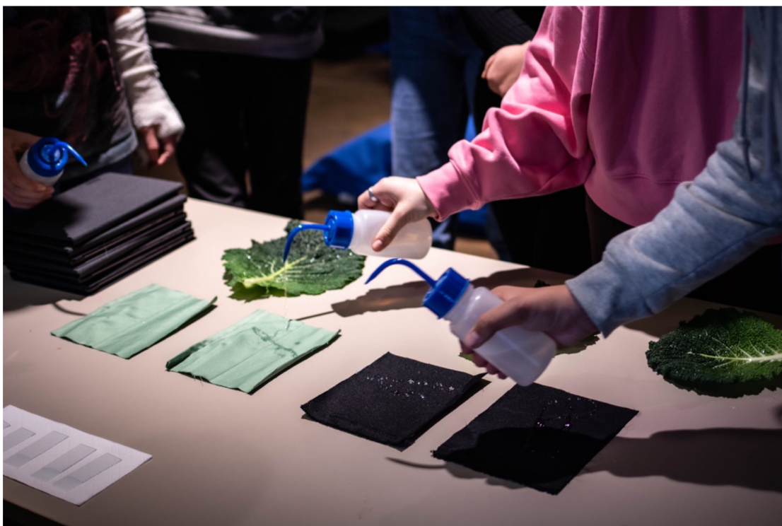
Obrázek č. 18: Ukázka žákovského laborování při aktivitě demonstrující hydrofobitu materiálů a lotosový efekt povrchů. [Fotografie z pilotní realizace výukového programu.]
