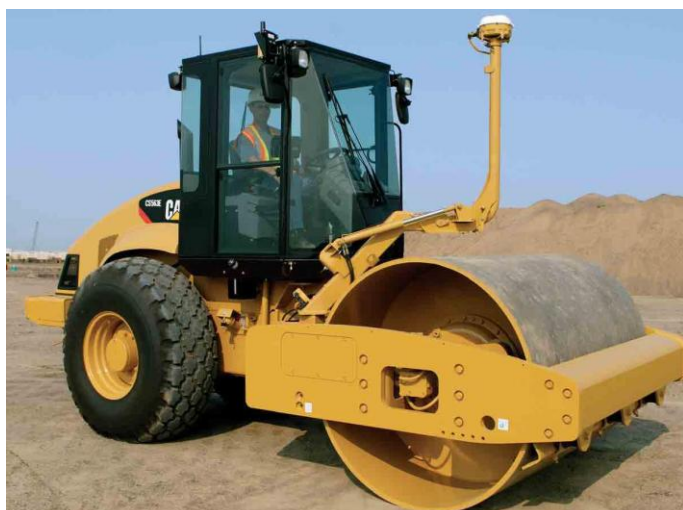
Obr. 6 Vibrační válec Caterpillar řízený metodou GPS
