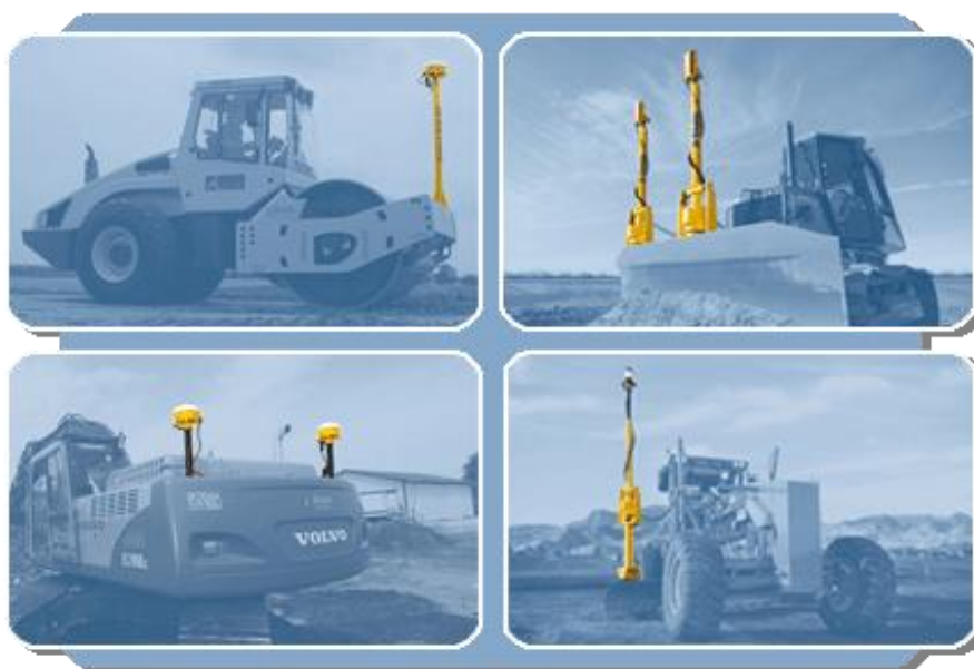
Obr. 1 Příklady zemních strojů vedených moderními přístroji
