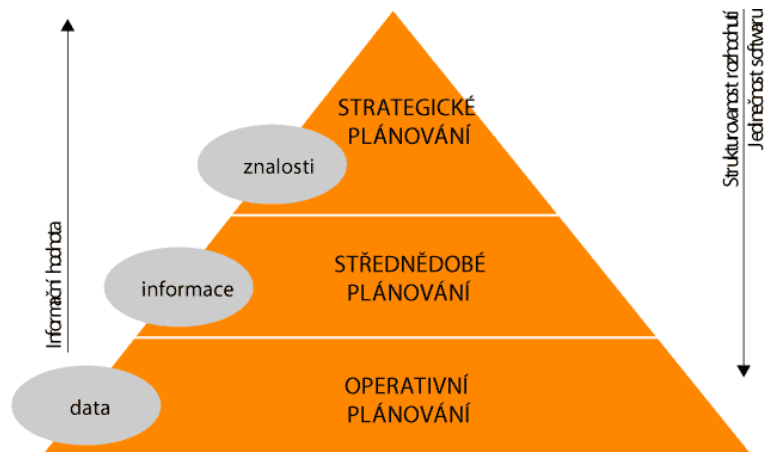
Obr. 4 Tříúrovňové schéma plánování a řízení výroby
