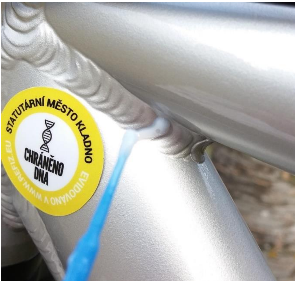
Obrázek 9: Aplikace forenzního identifikačního značení za použití aplikátoru. (Zdroj: Magistrátem města Kladna poskytnuto vybavení a materiál Policii ČR v rámci projektu FIZJK, fotografie vlastní)
