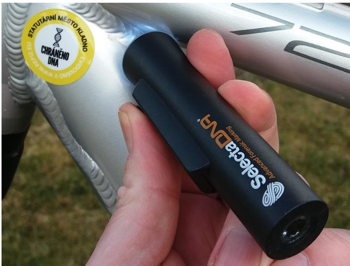
Obrázek 4: Kontrola forenzního značení monokulárním mikroskopem. (Zdroj: Magistrátem města Kladna poskytnuto vybavení a materiál Policii ČR v rámci projektu FIZJK, fotografie vlastní)
