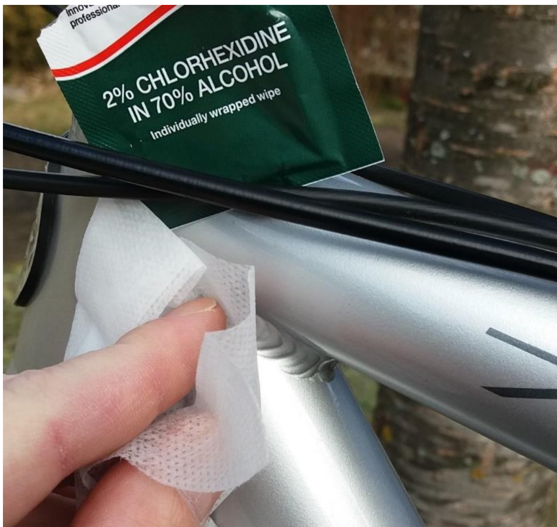
Obrázek 8: Očištění značeného místa před aplikací značení. (Zdroj: Magistrátem města Kladna poskytnuto vybavení a materiál Policii ČR v rámci projektu FIZJK, fotografie vlastní)
