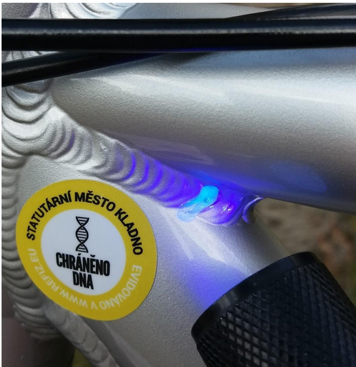
Obrázek 3: Kontrola forenzního značení UV světlem. (Zdroj: Magistrátem města Kladna poskytnuto vybavení a materiál Policii ČR v rámci projektu FIZJK, fotografie vlastní)
