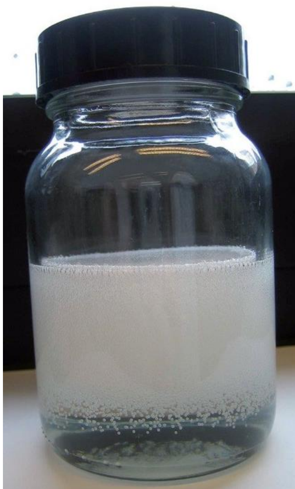
Obr. 17: Pryskyřice WEPURAN VT 3402 KK – vmíchané bublinky [24]
