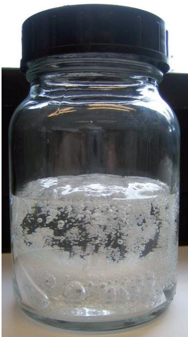
Obr. 18: Pryskyřice WEPURAN VT 3402 KK – vzdušná vlhkost [24]
