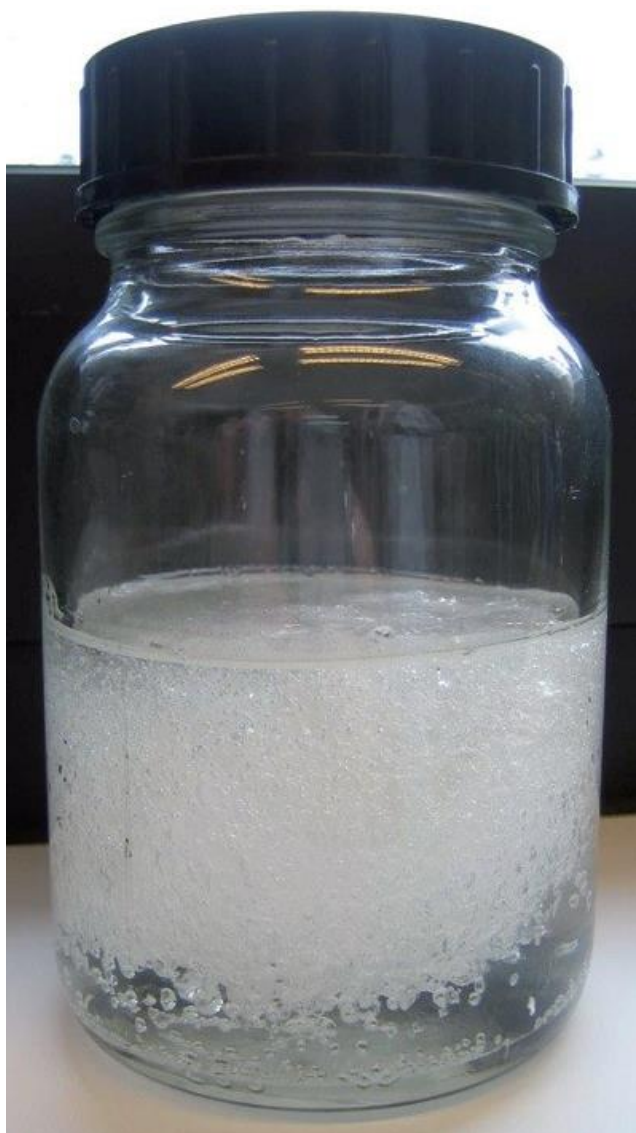
Obr. 19: Pryskyřice WEPURAN VT 3402 KK – špatný míchací poměr [24]
