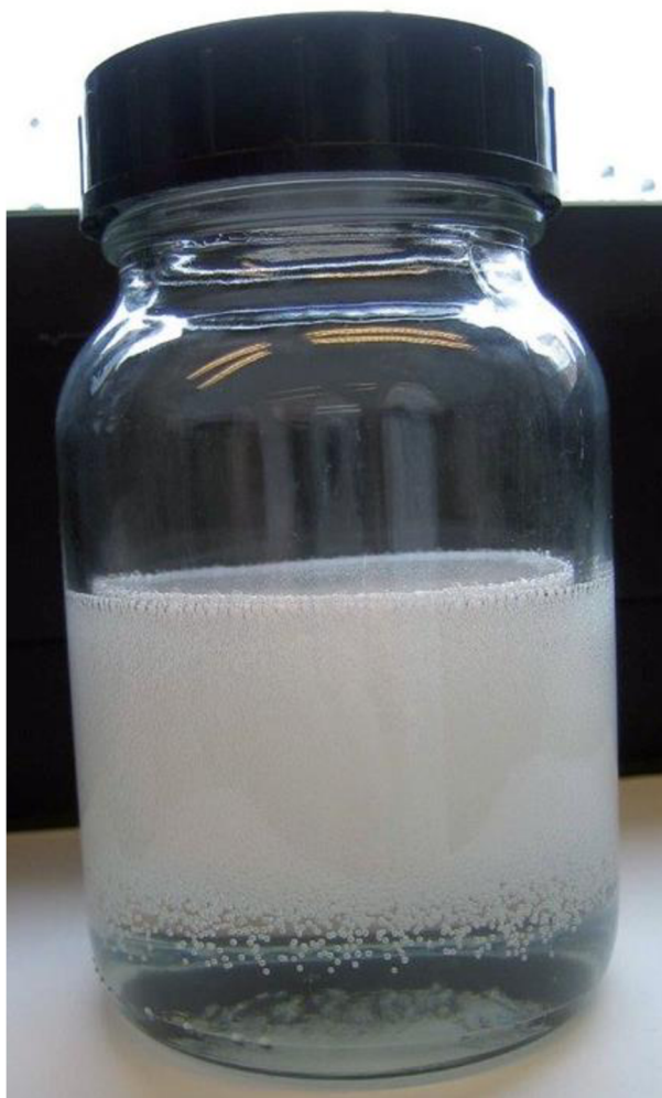
Obr. 17: Pryskyřice WEPURAN VT 3402 KK – vmíchané bublinky [24]
