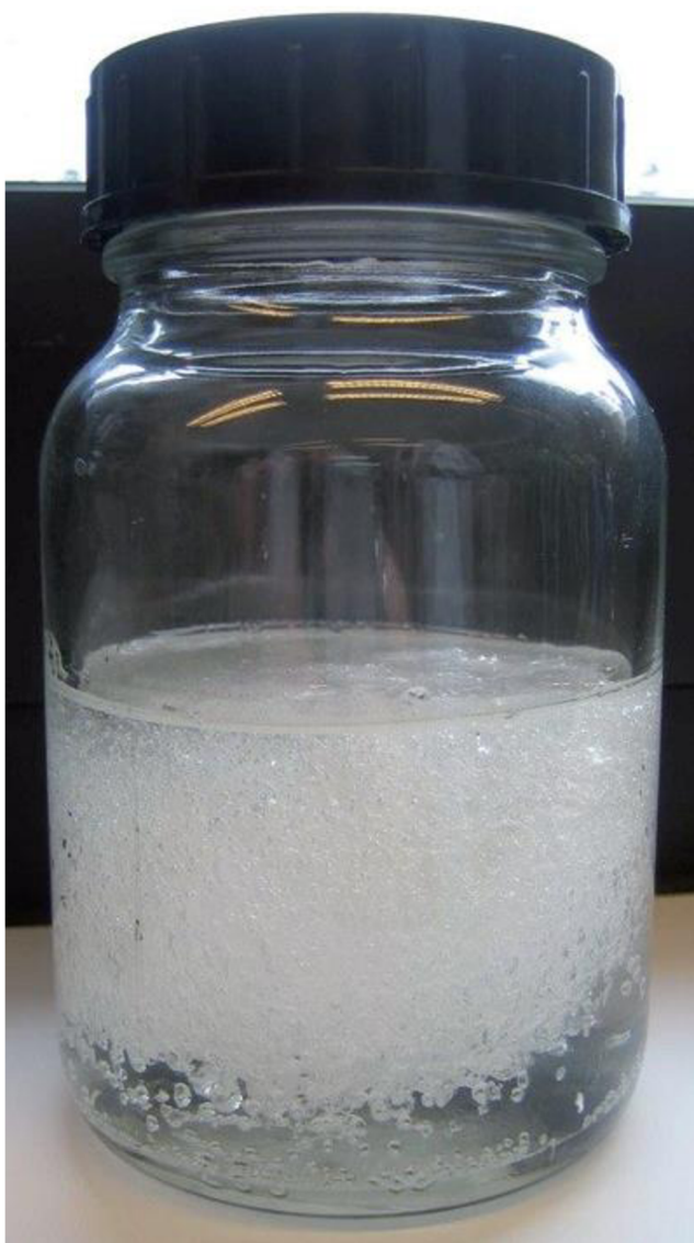
Obr. 19: Pryskyřice WEPURAN VT 3402 KK – špatný míchací poměr [24]
