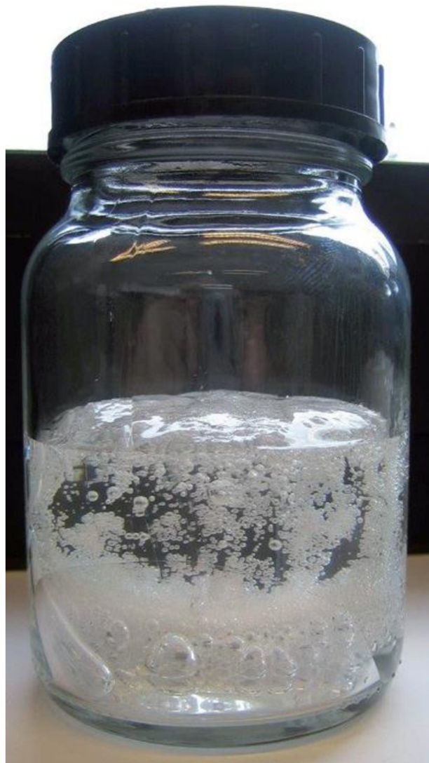
Obr. 18: Pryskyřice WEPURAN VT 3402 KK – vzdušná vlhkost [24]
