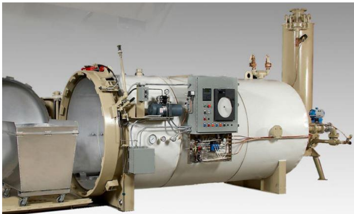
Obr. 8 Autokláv pro sterilizaci odpadu parou [38]
