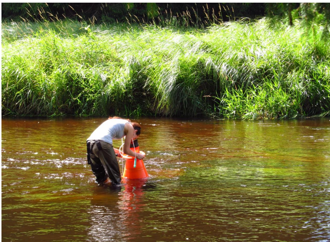
Příloha 7: Umístění a zajištění trvalé sondy pro odběr intersticiální vody; © Jan Švanyga
