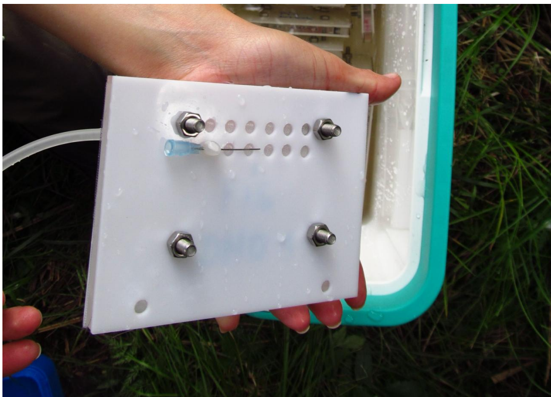
Příloha 7: Umístění a zajištění trvalé sondy pro odběr intersticiální vody; © Jan Švanyga
