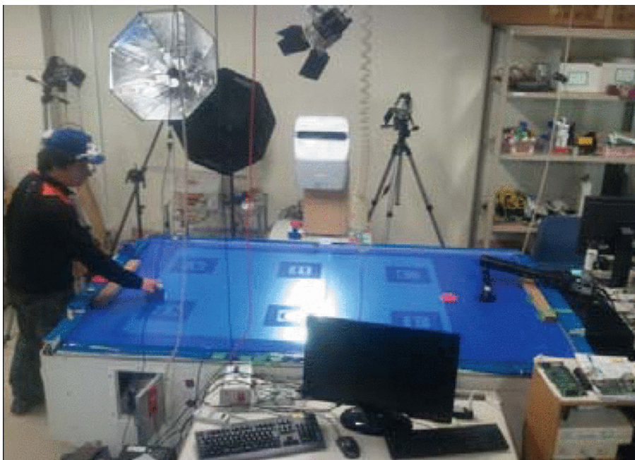
Obrázek 7: Fotka experimentální sestavy pro sledování pohybu očí lidského hráče [9]
