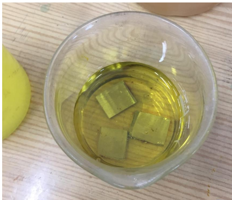
Obr. 43 Chemické čištění vzorků sloučeninou hexamethylentetramin.
