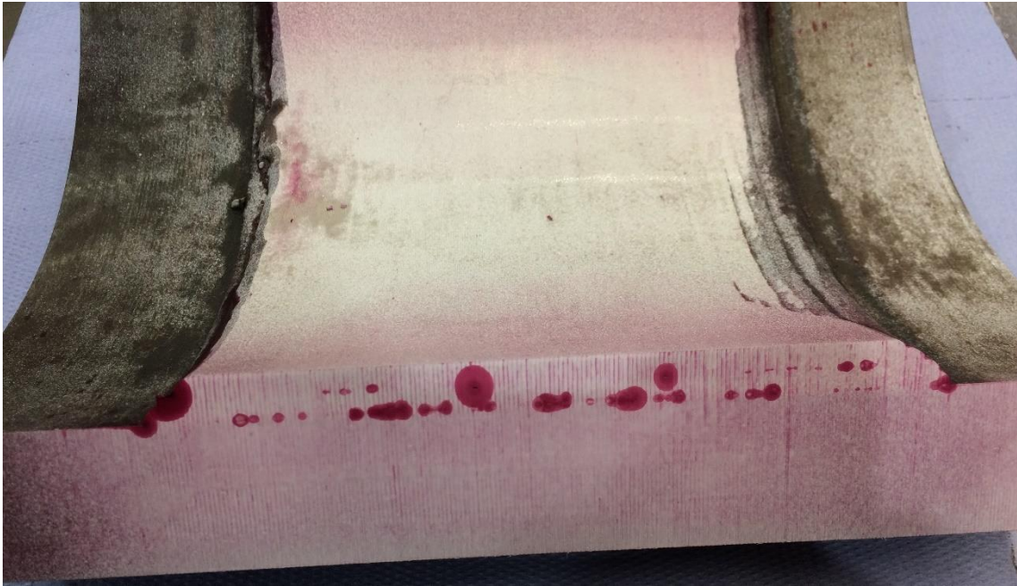
Obr. 30 Kapilární zkouška dvouvrstvého návaru z první sady.
