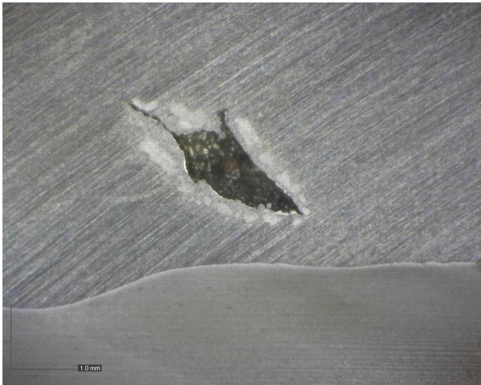
Obr. 37 Vada 4012 u dvouvrstvého návaru.
