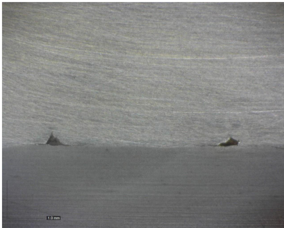
Obr. 35 Vznik studeného spoje na svarové ploše u jednovrstvého návaru.
