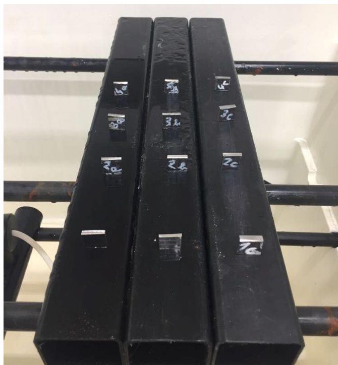
Obr. 42 Rozmístění vzorků niklové slitiny v solné komoře.
