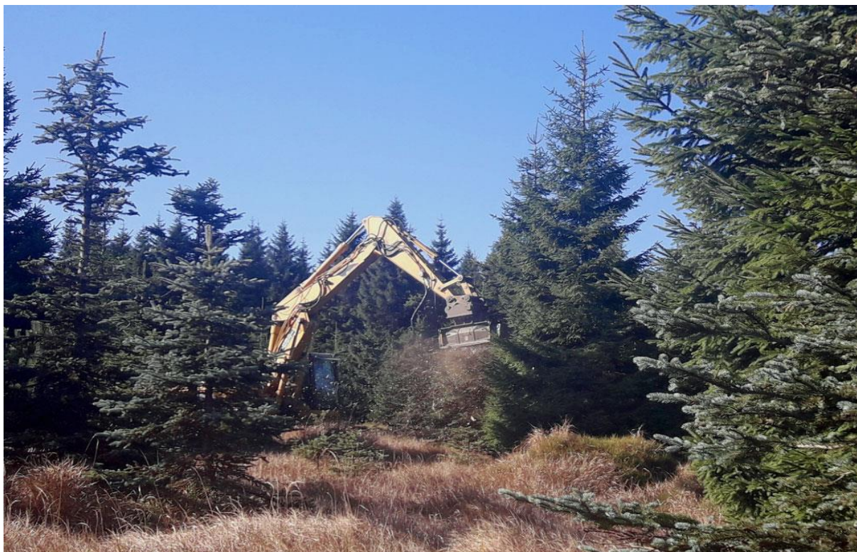
Obrázek 13: Rekonstrukce porostů SMP je možná bagrem se štěpkovací hlavicí, (Zdroj: LČR, s. p.).
