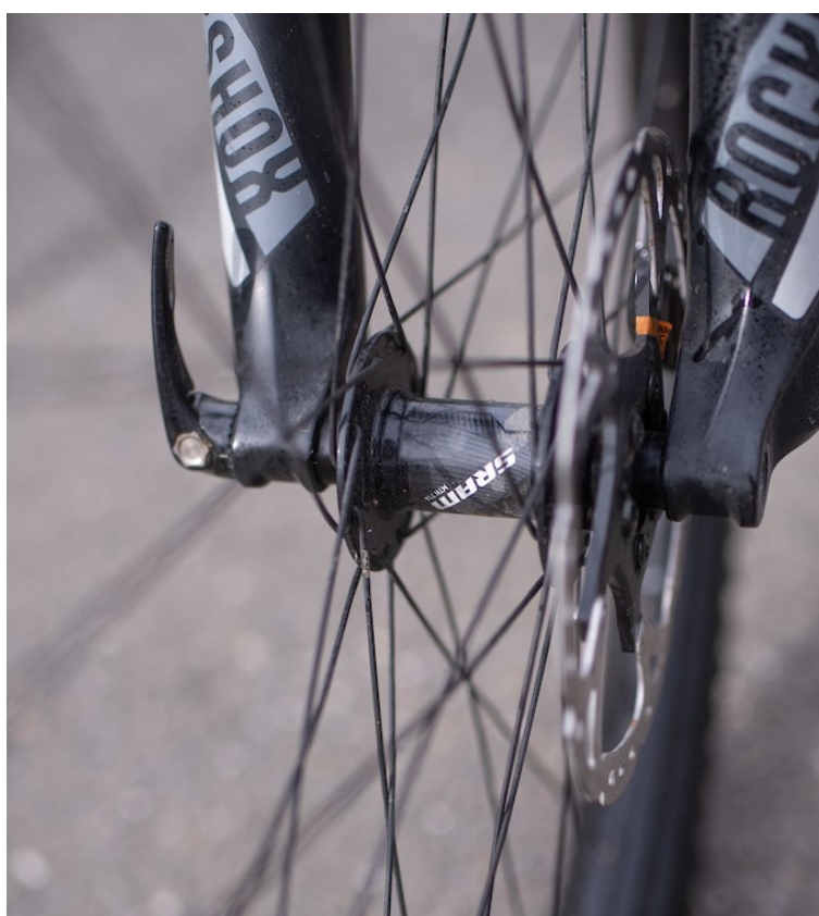
Obr. 2.1: Pohľad na umiestnenie náboja vzhľadom na vidlicu bicykla [25].
