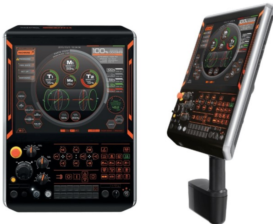
Obr. 1.4: Ovládací panel systému MAZATROL SmoothX [13].
