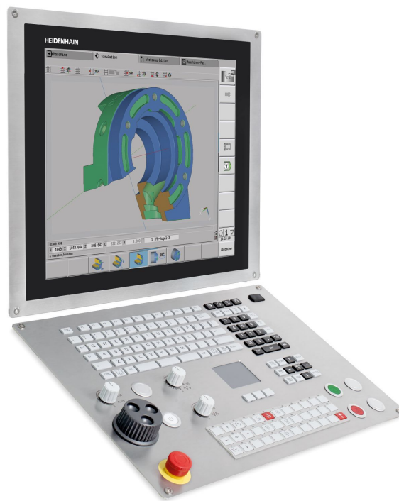
Obr. 1.3: Ovládací panel systému CNC PILOT 640 [10].
