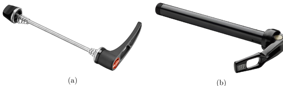
Obr. 2.4: Typy konštrukcie osiek, zľava \varnothing 5 mm oska s rýchlopínakom, \varnothing 15 mm pevná os [30, 31].
