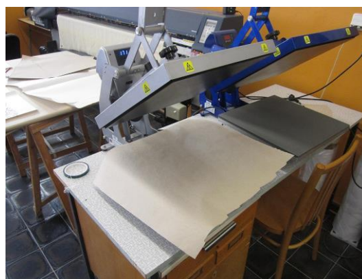
Obr. 65 Přenos desénu za pomoci tepelného lisu
