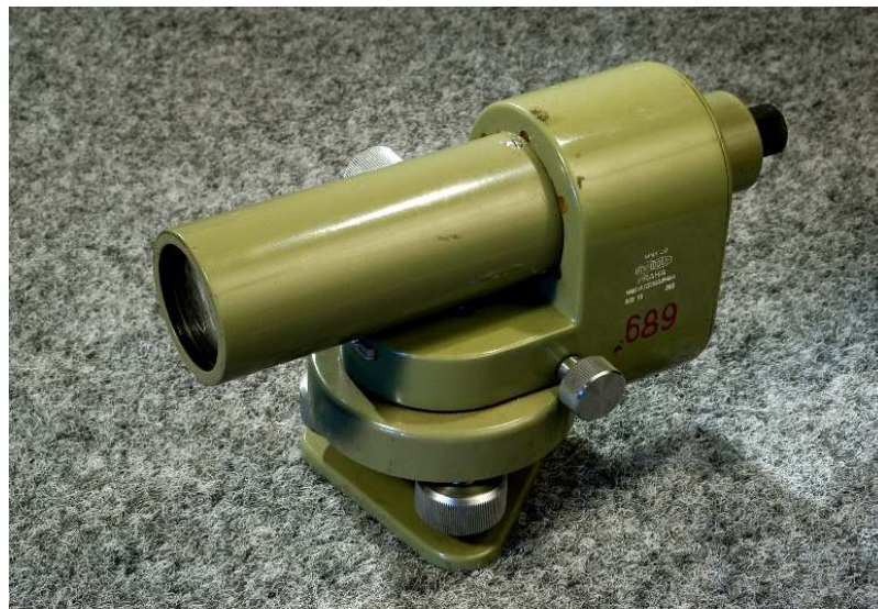
Obr. 4.3 Nivelační přístroj MEOPTA MNK20 [6]
