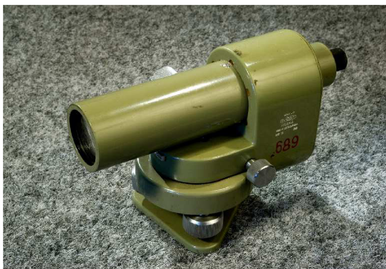
Obr. 4.3 Nivelační přístroj MEOPTA MNK20 [6]
