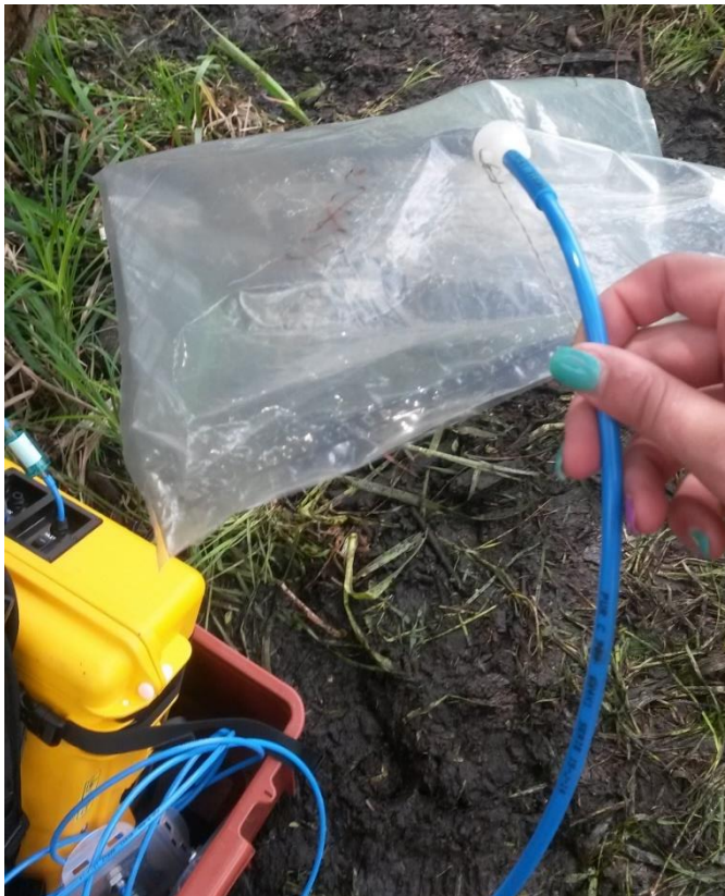
Obr. 25 Měření plynů ze sáčku, které se přečerpaly z půdní komory po 40-ti minutovém uzavření.
