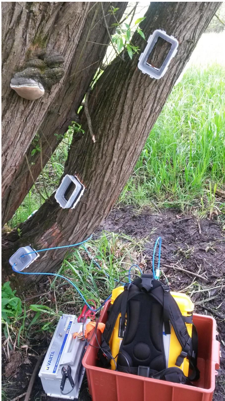
Obr. 23 Ukázka probíhajícího měření v komoře úrovně 1 na Salix pentandra . Foto: Janebová, 2016
