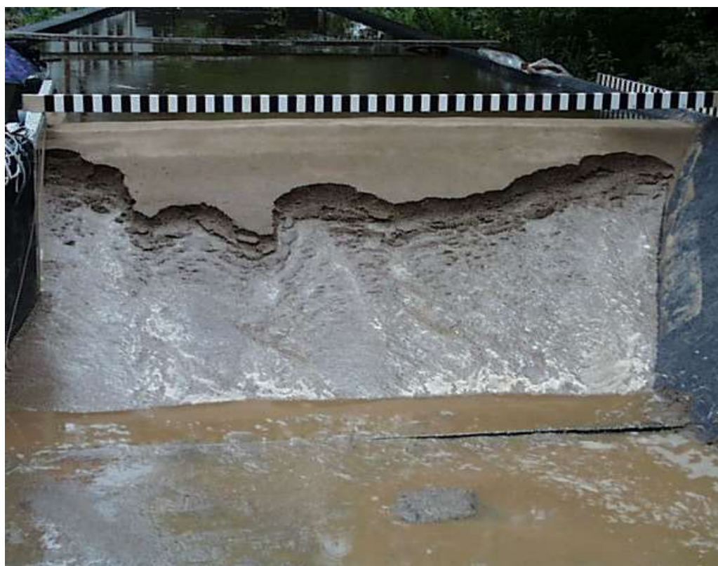
Obr. 3.23 Pohled na vzdušnou stranu porušeného modelu homogenní sypané hráze (Foto - Pařílková)
