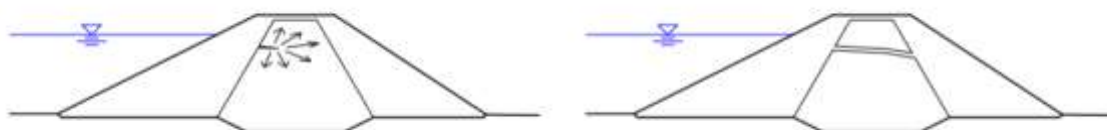
Obr. 3.3 Hydraulické trhání (Fell and Fry 2005)
