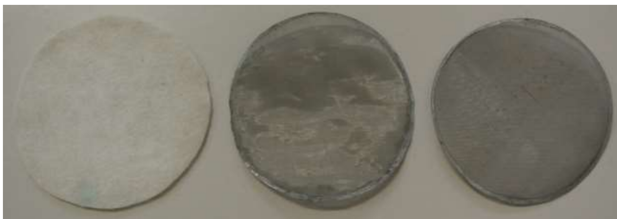
Obr. 9.4 Používaná síta a geotextilie
