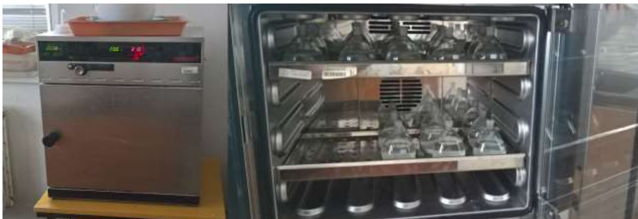
Obr. 8.11 Ochlazení: a) Termostat; b) Termostat s pyknometry
