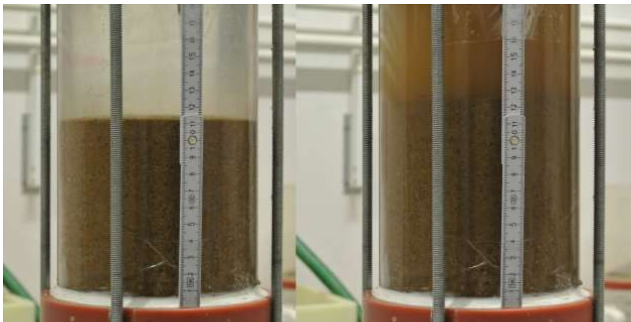
Obr. 11.2 Ztekucení ve vertikálním propustoměru (vlevo: lokální poruchy – kritický hydraulický gradient, vpravo: ztekucení)
