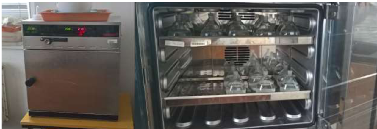
Obr. 8.11 Ochlazení: a) Termostat; b) Termostat s pyknometry
