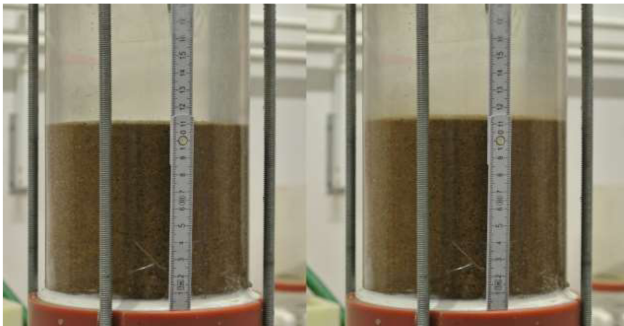
Obr. 11.1 Nadzvednutí ve vertikálním propustoměru (vlevo: bez porušení, vpravo: protažení)
