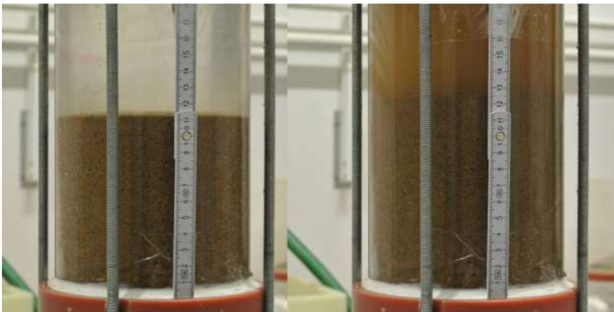
Obr. 11.2 Ztekucení ve vertikálním propustoměru (vlevo: lokální poruchy – kritický hydraulický gradient, vpravo: ztekucení)
