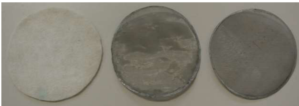
Obr. 9.4 Používaná síta a geotextilie
