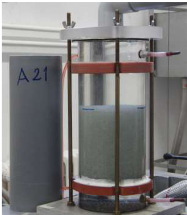
Obr. 5.6 Vertikální propustoměr zapojený do soustavy se skleněnými kuličkami (Alhasan a kol., 2015)
