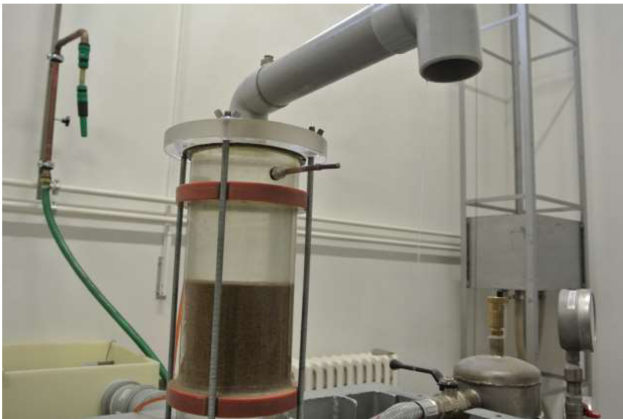
Obr. 10.3 Propustoměr zapojený do soustavy
