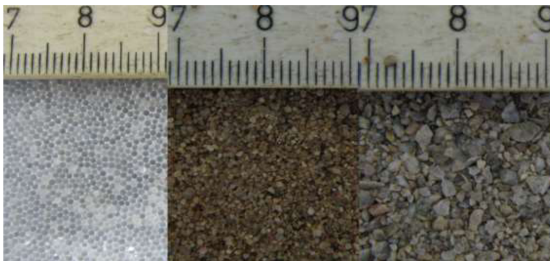
Obr. 8.13 Fotoaparát: a) Kulová zrna; b) Zaoblená zrna; c) Ostrohranná zrna
