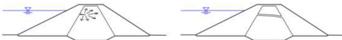
Obr. 3.3 Hydraulické trhání (Fell and Fry 2005)
