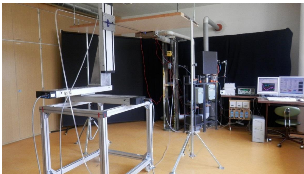
Obr. 3.5 Měřicí trať, v popředí je k vidění traverzovací systém
