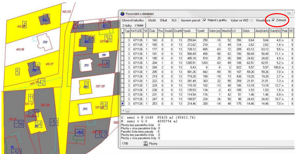
Obr. 50 – Barevné rozlišení rozdílů výměr v grafice
