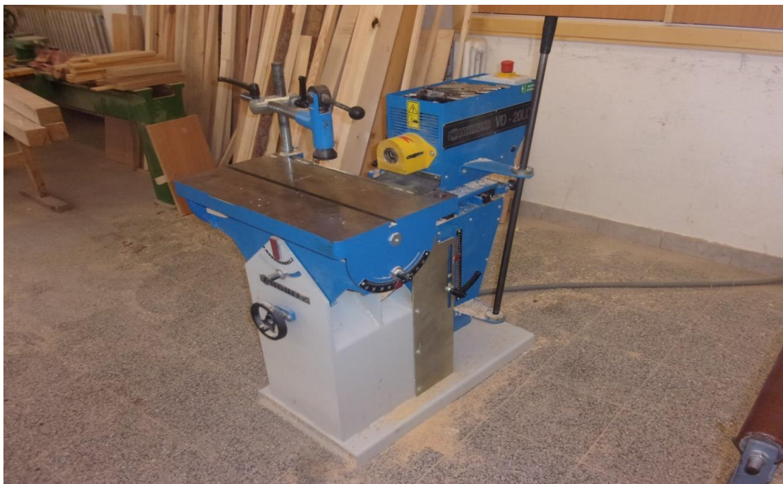
Obr. č. 15 Vrtací dlabačka – 3. blok (foto: autor)
