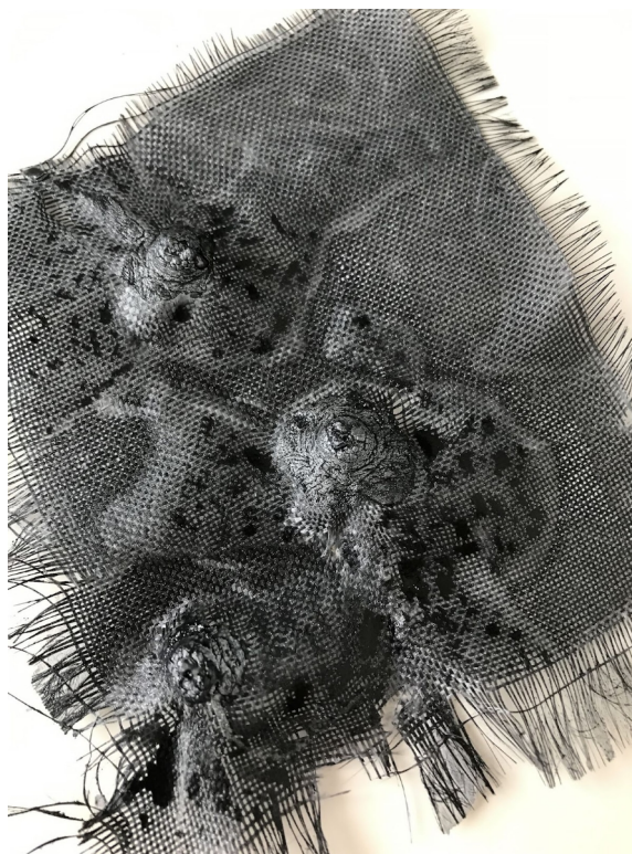
Obr. 23 Odlitek UV pryskyřici zalitý ve skelné tkanině
