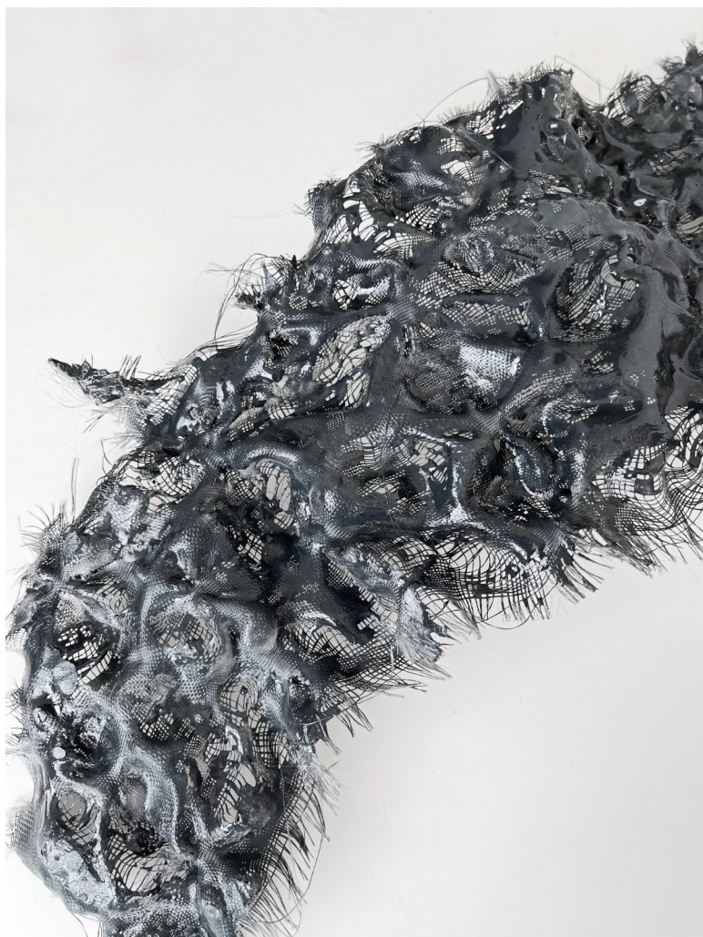
Obr. 31 Zkouška se skelnou tkaninou s UV pryskyřicí
