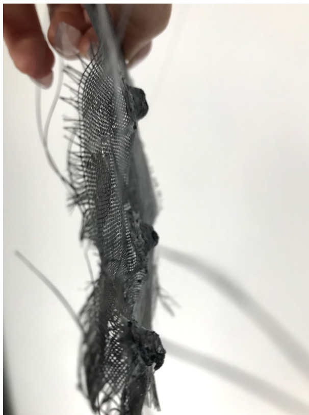
Obr. 24 Odlitek tvořený UV pryskyřici zalitý ve skelné tkanině
