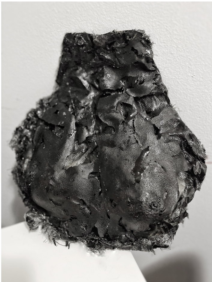
Obr. 35 Zkouška s odlitkem hrudi, UV pryskyřice a kevlar
