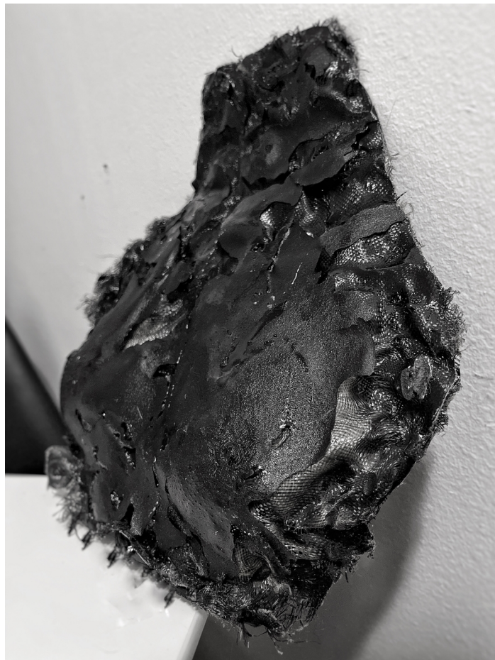
Obr. 36 Zkouška s odlitkem hrudi, UV pryskyřice a kevlar
