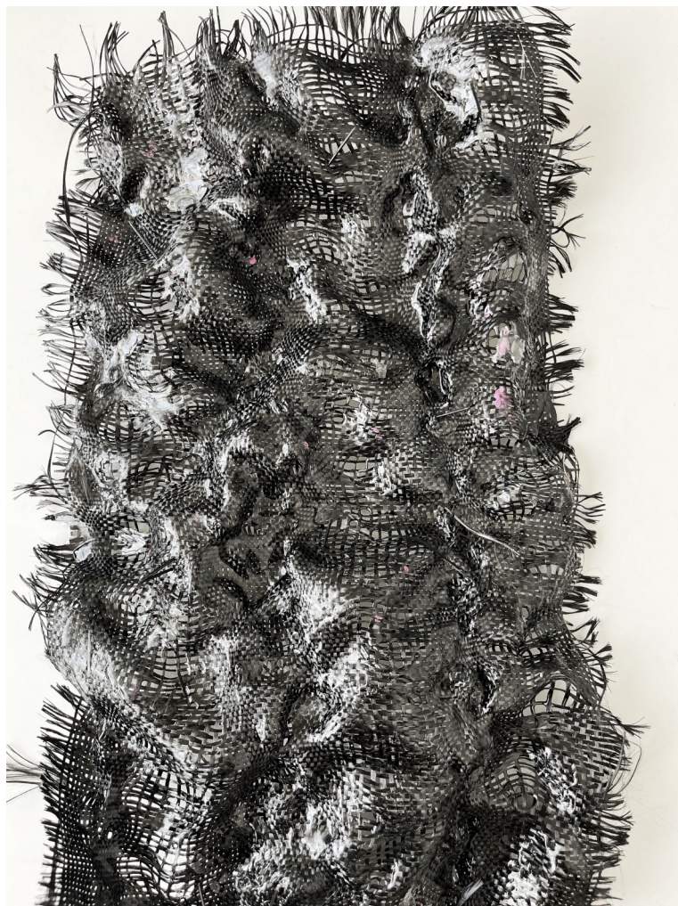
Obr. 32 Zkouška s uhlíkovou tkaninou, hřebíky a UV pryskyřicí
