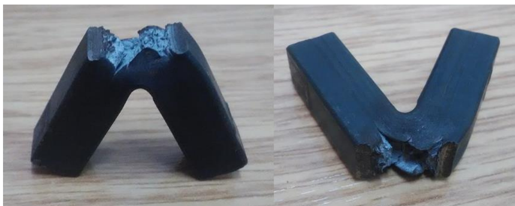
Obrázek 19: Neúplný lom zkušebního vzorku
