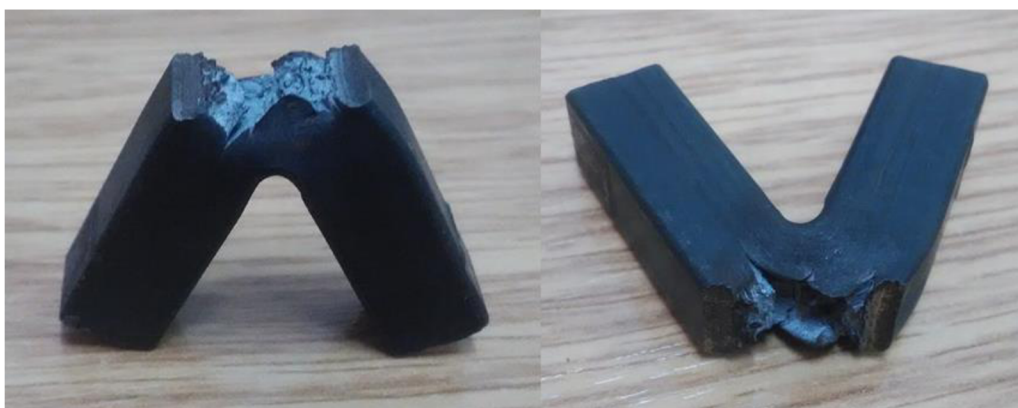
Obrázek 19: Neúplný lom zkušebního vzorku
