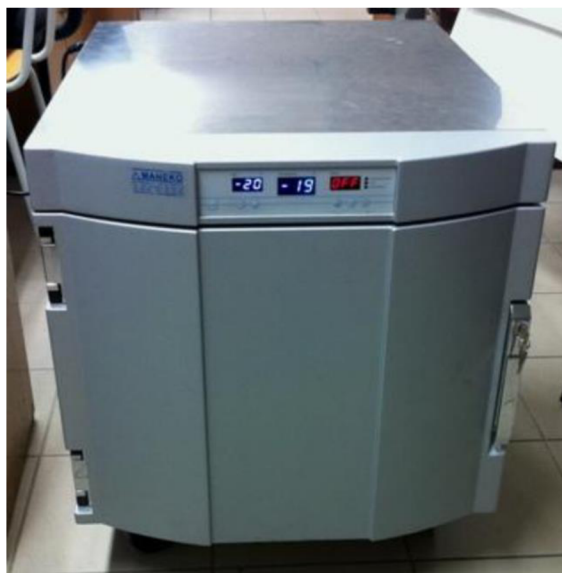
Obrázek 12: laboratorní mraznička ProfiMaster PMU 0450
