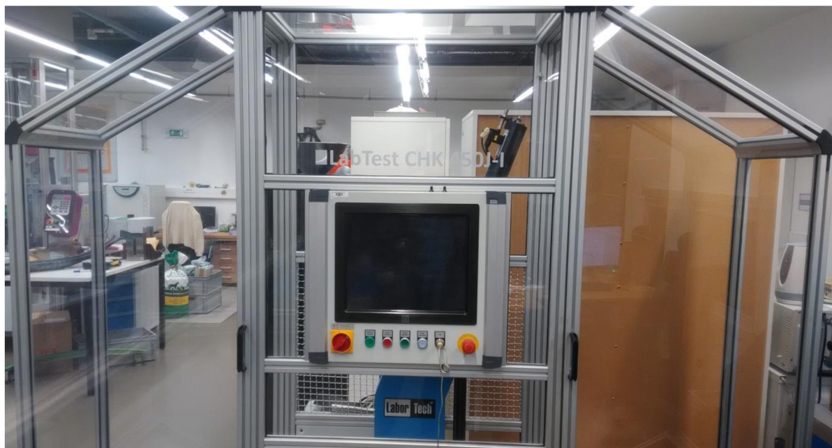
Obrázek 13: Rázové kladivo LabTest CHK 450J-I
