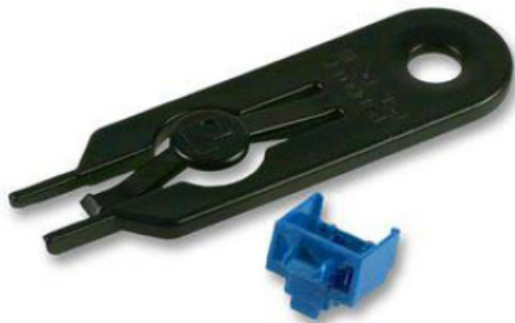
Obrázek 6: Datová zásuvka s omezenou přístupností portů (15)
