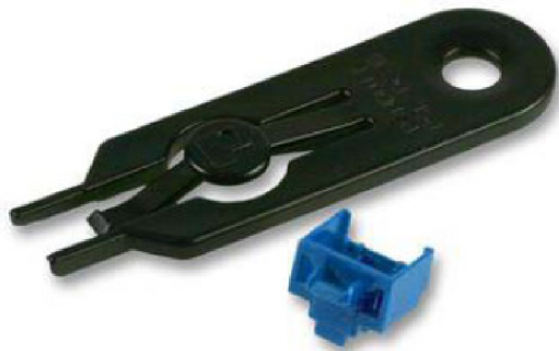
Obrázek 6: Datová zásuvka s omezenou přístupností portů (15)
