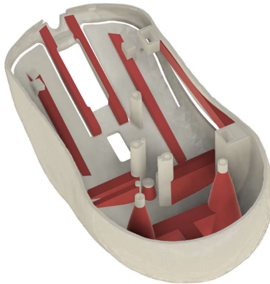
Obr. 46 výztuhy v horním dílu myši.
