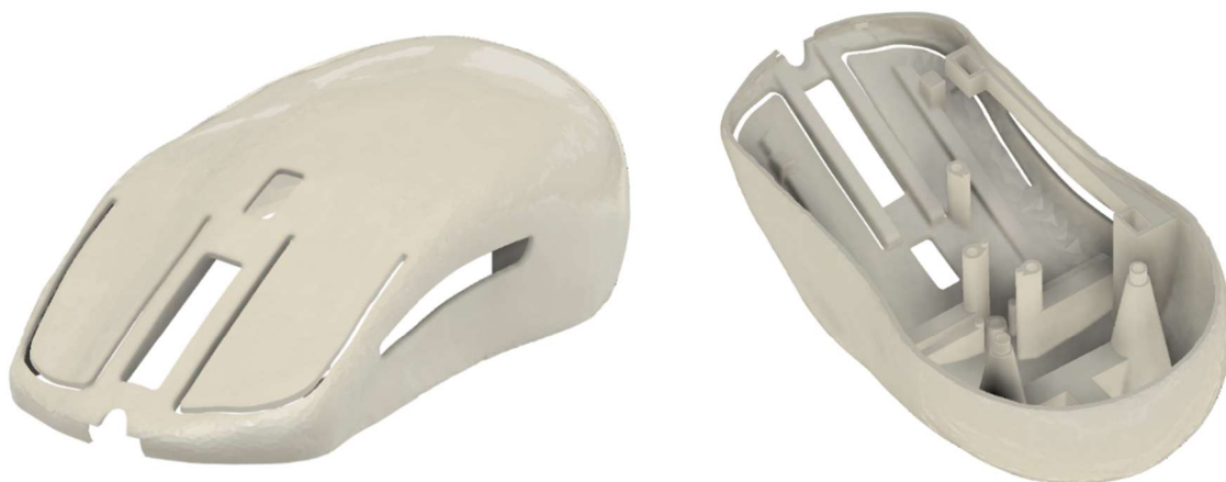
Obr. 36 Upravený model myši v CAD softwaru.
