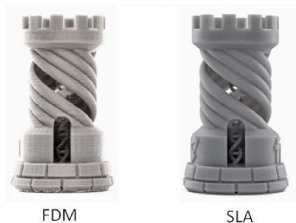
Obr. 17 Porovnání FDM a SLA 3 D výtisků [27].
