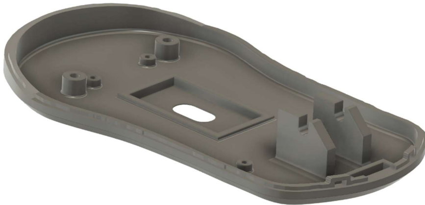
Obr. 37 Model spodního dílu myši vymodelovaný v CAD softwaru.
