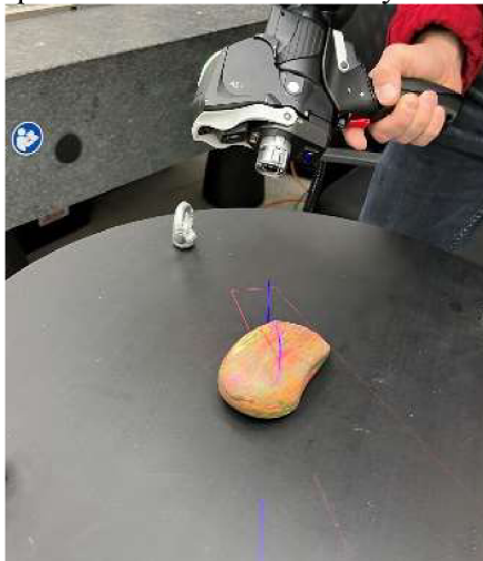
Obr. 30 Skenování vrchního dílu.
