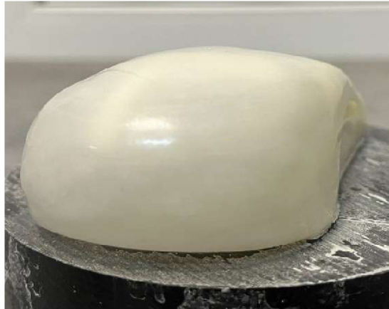
Obr. 44 Povrch výtisků po zjemnění acetonem.
