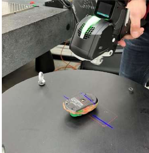
Obr. 32 Skenování spodní části počítačové myši.
