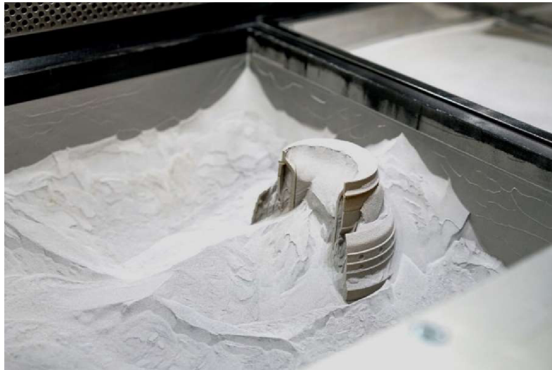
Obr. 18 Ukázka zasypání modelu při metodě SLS 3D tisku [28].
