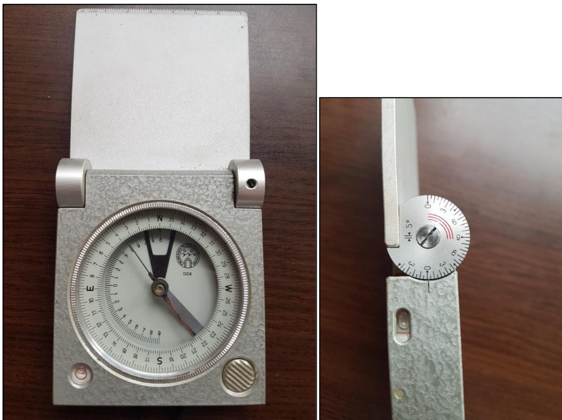
Obrázek 17 - Geologický kompas, boční strana geol. Kompasu s výklopnou deskou s velikostí sklonu (foto J. Chlupáč, 2021)
