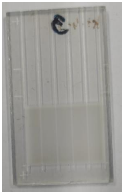
Obrázek 25: Ukázka pětielektrodového systému, na kterém jsou natištěny tři vrstvy kompozice namletých částic.
