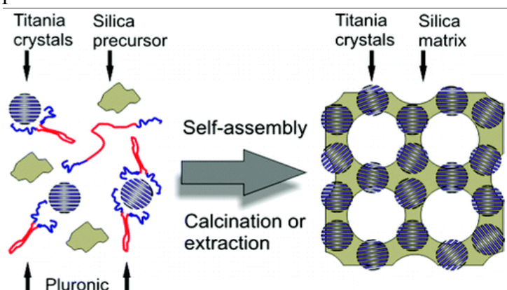
Obrázek 15: Formování nanokompozitního mezoporézního filmu \text{TiO}_2 - \text{SiO}_2 [40]
