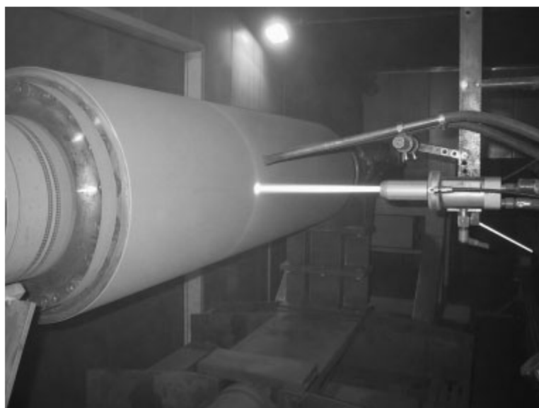
Obr. 2.8 Typická aplikace HVOF – povlakování válců pro tiskařský průmysl [6]
